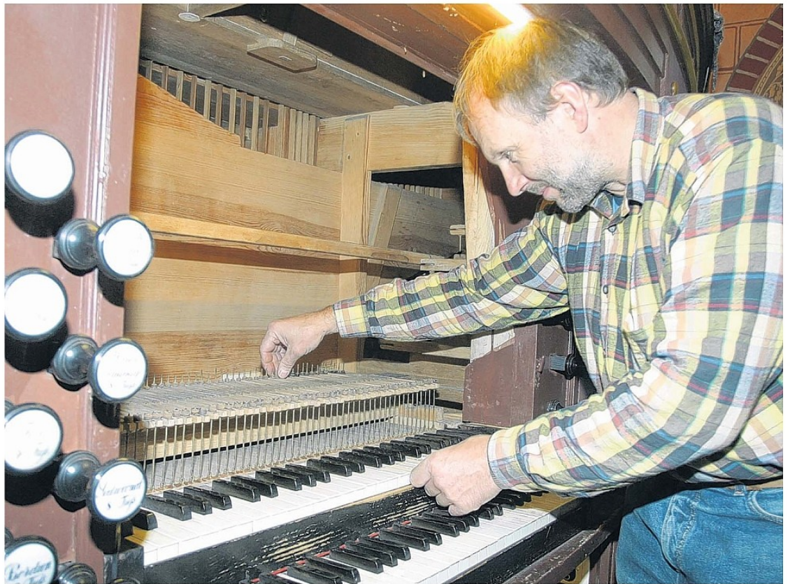
Die Mechanik der Wotenicker Orgel überprüft Michael Helterhoff. Das Instrument wird derzeit überholt.
